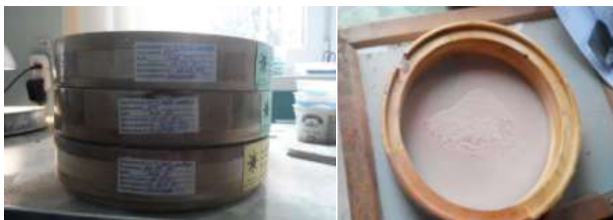
Рис. 1. Общий вид сит для определения дисперсности бленды
