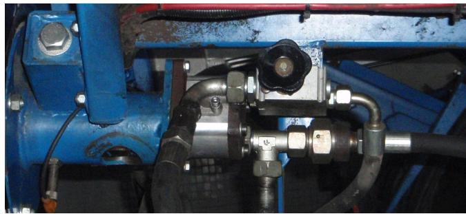
Рис. 19. Вентиль регулировки частоты вращения вентилятора.
