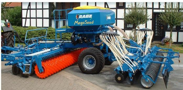
Рис. 13. Почвообрабатывающе-посевной агрегат «MegaSeed».
