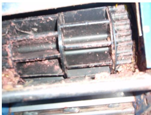
Рис. 21. Вид высеивающего аппарата
