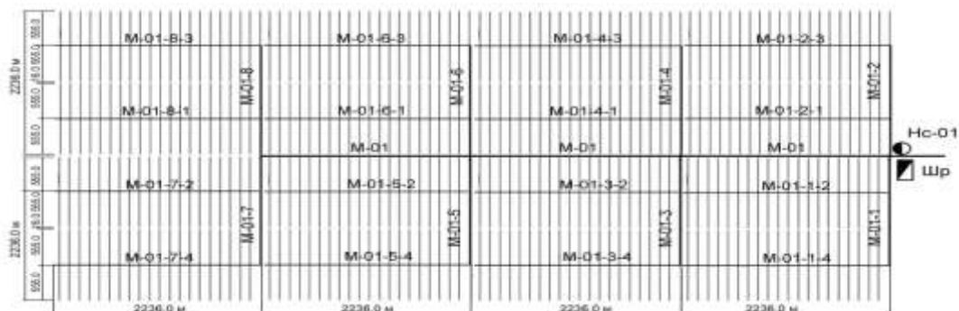
Рис. 1. Топология польдерной системы, использованной в численных экспериментах при расчете эффективности ее работы для плотности проводящих каналов L_{\text{кан}} = 12,3 м/га
