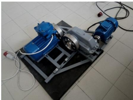
Рис. 2. Лабораторная установка вибровалкового измельчителя
