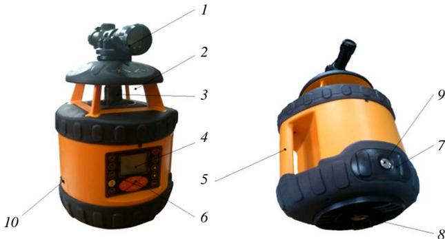
Рис. 7.25. Лазерный излучатель: *1* – телескопический визир; *2* – окошки лазерного луча; *3* – вращающаяся головка; *4* – дисплей; *5* – ручка; *6* – клавишная панель; *7* – крышка батарейного отсека; *8* – адаптер с резьбой 5/8"; *9* – винт крышки батарейного отсека; *10* – гнездо зарядного устройства
