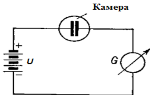
Рис. 24. Схема включения токовой ионизационной камеры: U – напряжение на электродах камеры; G – гальванометр, измеряющий ионизационный ток
