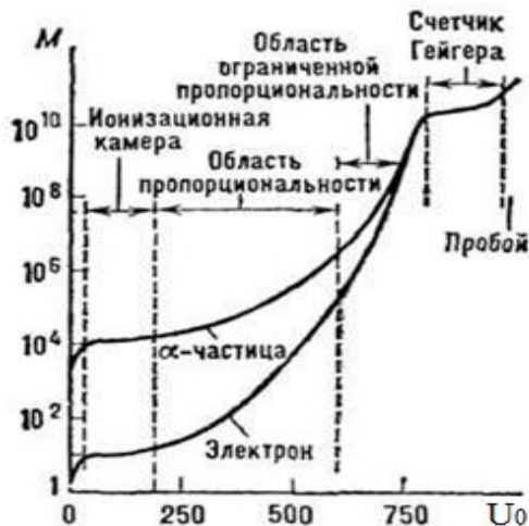
Рис. 28. Вольт-амперная характеристика газового разряда
