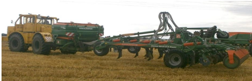
Рис. 1. Почвообрабатывающе-удобрительный комбинированный агрегат компании «AMAZONEN-Werke», состоящий из бункера X-Tender-4,2 и культиватора мульчировщика-глубокорыхлителя Senius
