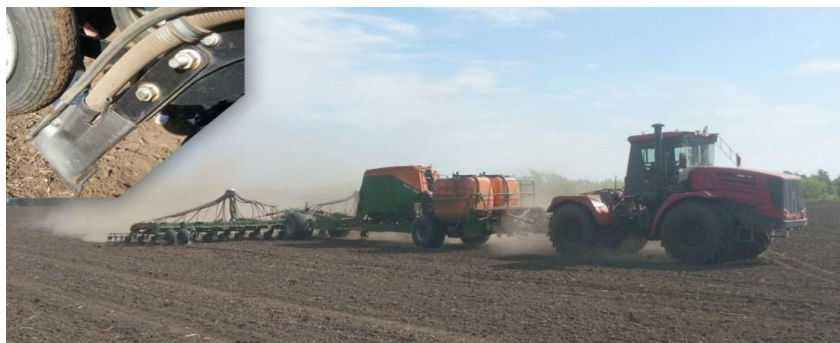
Рис. 2. Универсальный агрегат FDC 6000 с сеялкой Condor 12000 с долотовидными сошниками для прямого посева и приспособлением для одновременного внутрипочвенного внесения жидких минеральных удобрений
