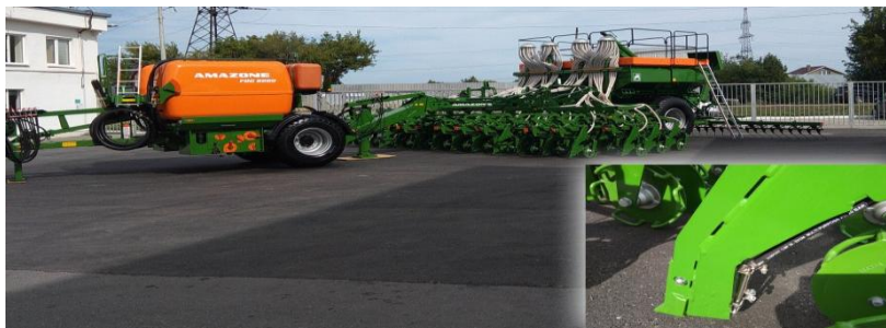
Рис. 1. Универсальный агрегат FDC 6000 с сеялкой Primera DMC 9000, оборудованной системой подачи жидких удобрений под анкерный сошник
