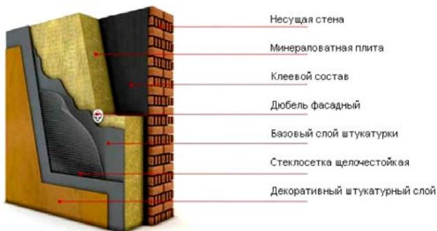
Рис. 15. Конструкция наружной стены с оштукатуренным фасадом
