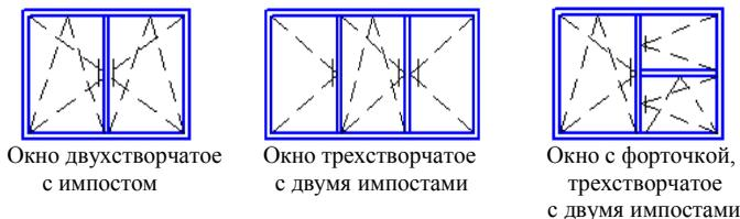
Рис. 75. Эскизы конструкции окон размером  $15 \times 18$  дм
