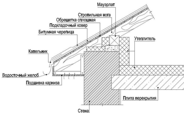
Рис. 118. Вариант устройства карнизного свеса крыши с покрытием из битумной черепицы
