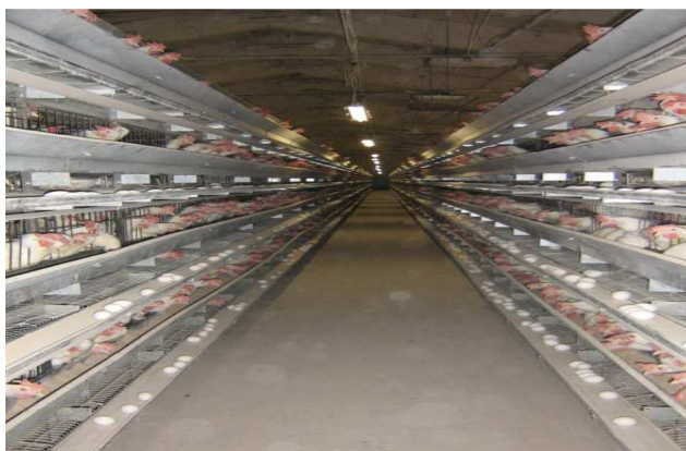
Рис. 2. Клеточное оборудование типа «Евровент-500» для содержания промышленного стада кур-несушек
