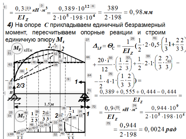
Рис. 3. Перемножение эпюр способом Верещагина
