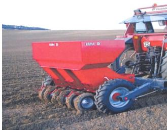
Рис. 14. Сеялка для посадки лука-севка и чеснока
