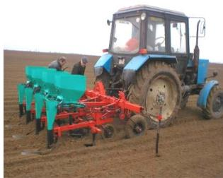
Рис. 15. Сеялка МПЛС-4 для посадки чеснока
