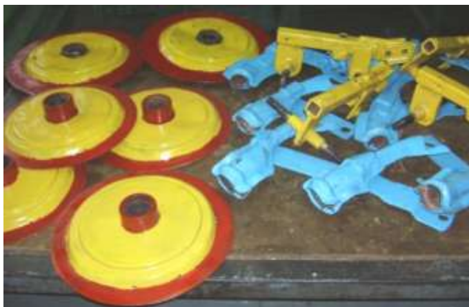
Рис. 3.9. Различные варианты дисков с ребордами-бороздкообразователями, корпусов и семянаправителей к экспериментальным двухдисковым сошникам
