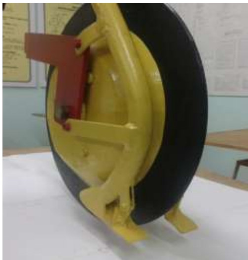
Рис. 3.20. Новый макетный образец однодискового сошника с симметричными двухсторонними ребрами-бороздкообразователями (вид сзади)
