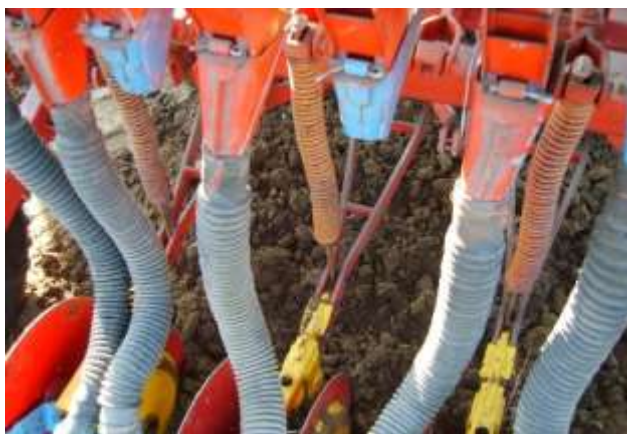
Рис. 4.2. Макетный образец двухдискового сошника без угла атаки дисков при давлении пружины 160 Н (16 кг)
