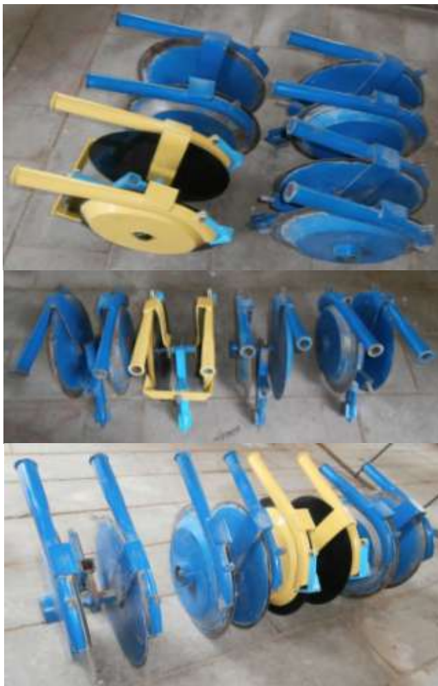
Рис. 3.18. Опытная партия сошников для двухстрочного посева
