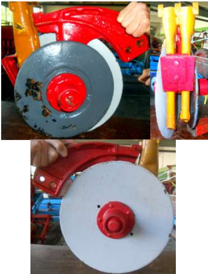
Рис. 1.100. Комбинированный двухдисковый сошник с разновеликими дисками для одновременного высева двух различных культур 8.8.3.(5.3).(7.5).3.1.3.1.8.8.3.1.4.8.6.3.(5.4).2.4.9.2
