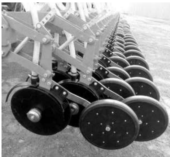
Рис. 1.96. Двухдисковые сошники с минимальным углом атаки дисков, с прикатывающим катком (производство ЕС) 3.1.1.2.1.2.3.7.4.2.3.3.3.2.1.4.2.2.2.3
