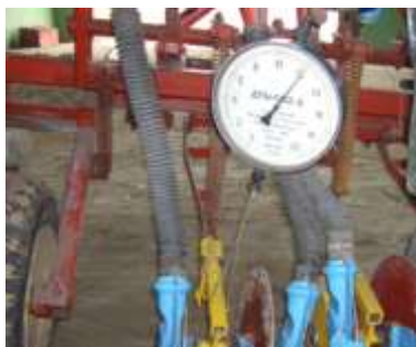
Рис. 4.6. Определение усилия давления пружины на двухдисковый сошник с ребрами-бороздкообразователями (на нижнем отверстии штанги)
