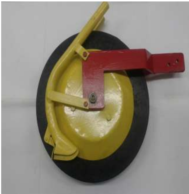
Рис. 3.19. Новый макетный образец однодискового сошника с симметричными ребрами (вид сбоку)
