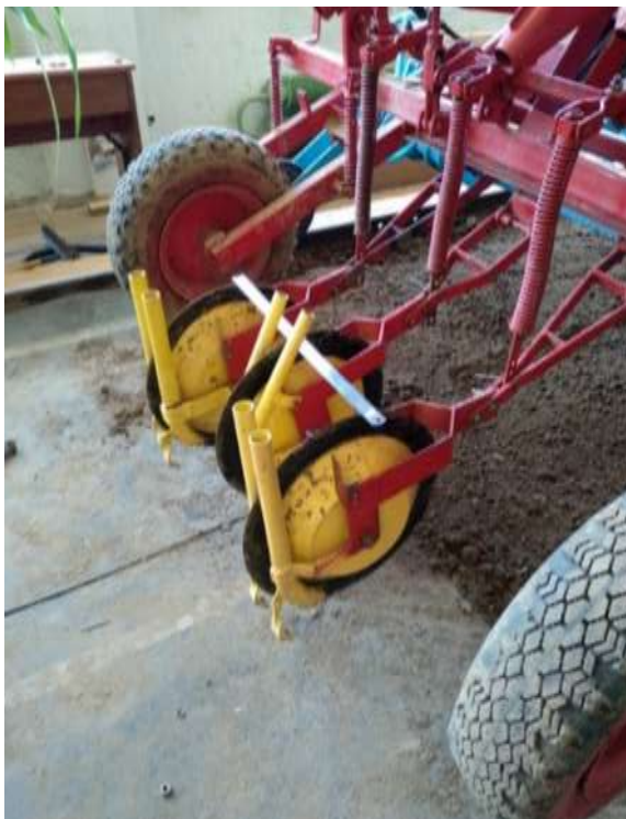
Рис. 4.20. Подготовка однодисковых сошников с изменяемой шириной реборды к лабораторным поисковым исследованиям
