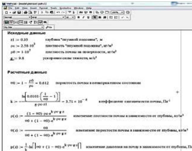
Рис. 2.20. Блок исходных и расчетных данных реализации моделей (2.78)–(2.80)
