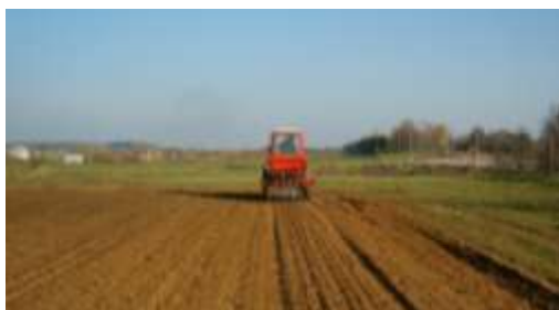
Рис. 4.5. Вид на опытную делянку после прохода селекционной сеялки с двухдисковыми сошниками и коническими бороздкообразователями-уплотнителями при скорости движения 14 км/ч
