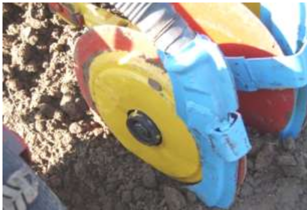
Рис. 4.1. Макетный образец двухдискового сошника с ребровой-бороздкообразователем в почве
