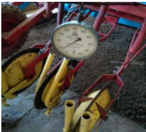
Рис. 4.21. Подготовка к поисковым исследованиям однодисковых сошников с изменяемым давлением
