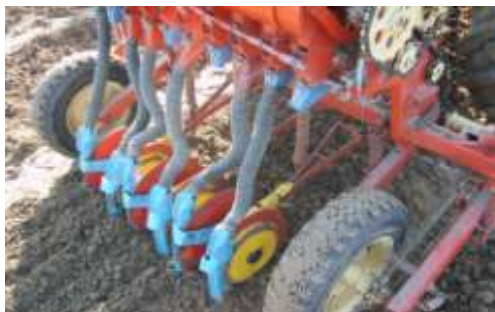
Рис. 4.3. Селекционная сеялка при высеве семян двухдисковыми сошниками с ребрами-бороздкообразователями
