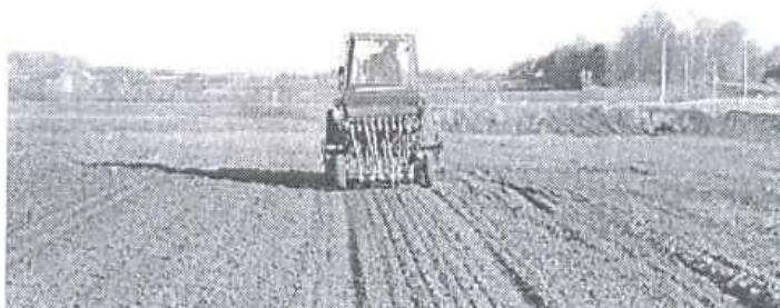
Рис. 5.2. Вид на опытную делянку после прохода трактора Т-25 с модернизированной селекционной сеялкой с экспериментальными двухдисковыми сошниками, расставленными в один ряд, с расстоянием между соседними рядками 0,125 м и скоростью движения 4 м/с
