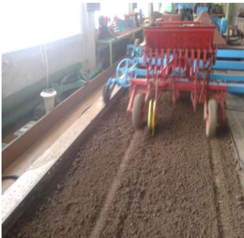
Рис. 3.27. Вид на бороздку после прохода однодискового сошника на скорости 8,6 км/ч
