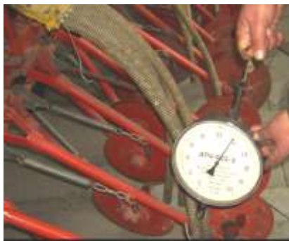
Рис. 4.8. Определение усилия давления пружины на однодисковый сошник пневматической сеялки С-6
