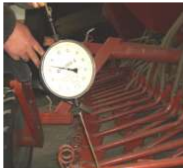
Рис. 4.9. Определение усилия давления пружины на килевидный сошник пневматической сеялки СПУ-6
