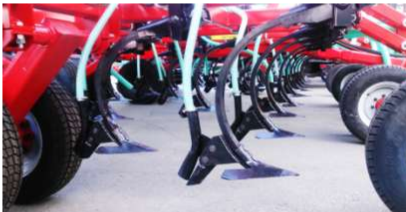
Рис. 1.14. Наральниковые сошники для припосевного внесения основной дозы минеральных удобрений
