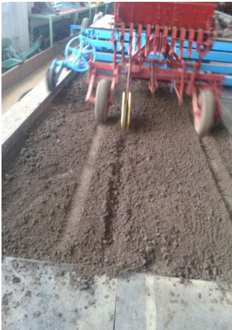
Рис. 3.28. Вид на бороздку после прохода макетного образца однодискового сошника на скорости 10,3 км/ч
