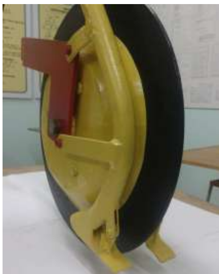
Рис. 1.98. Однодисковый сошник с нулевым углом атаки и крена 3.7.9.6.4.3.2.1.4.3.8.3.2.1.4.2.1.1.5.3.1.1
