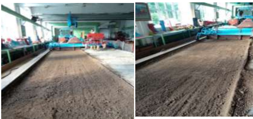
Рис. 4.19. Подготовка почвы (почва суглинистая) к поисковым исследованиям с выравнителем, установленным на тяговую тележку
