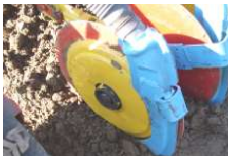
Рис. 3.19. Макетный образец двухдискового сошника с ребровой-бороздообразователем в почве
