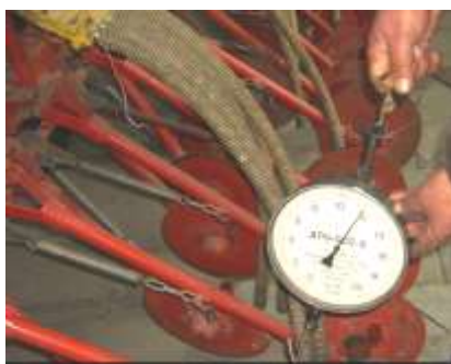
Рис. 3.26. Определение усилия давления пружины на однодисковый сошник пневматической сеялки С-6
