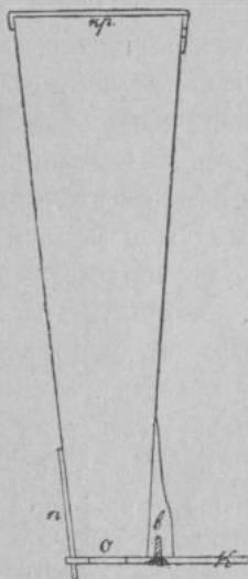
Рис. 16. Посѣвной рожекъ съ крышкою кр. и съ кружкомъ к ; с —винтъ, держащій рожекъ; п —пружина; о —отверстіе кружка.
