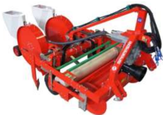
Рисунок 4 – Комбинированная машина для посева с мульчированием пленкой Sparreri SMP
