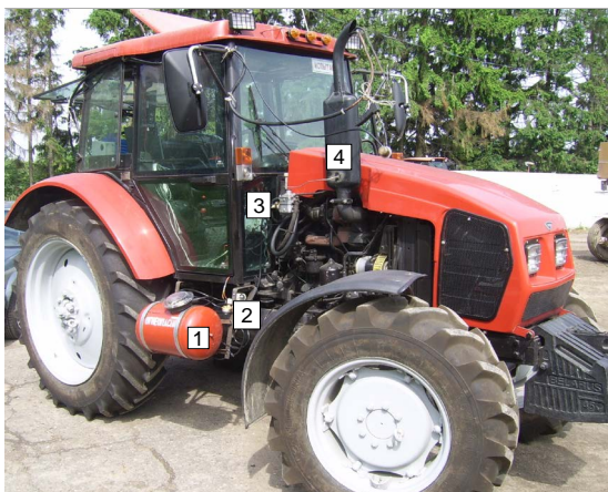
Рис. 2. Трактор «Беларус-922» с системой подачи газового топлива: 1 – газовый баллон; 2 – выносное заправочное устройство; 3 – газовый редуктор; 4 – датчик температуры отработанных газов
