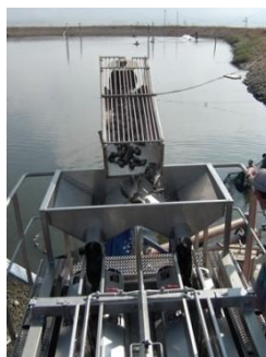
Рис. 3. Устройство сортировочной машины ленточного типа
