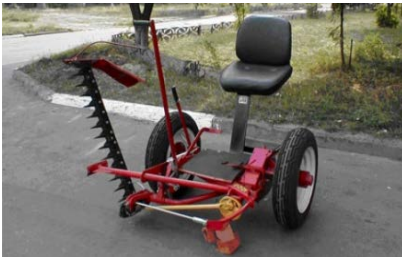
Рис. 5.4. Косилка конная КТ03.00.000(КТ-1) и грабли конные ГАК-2,1
