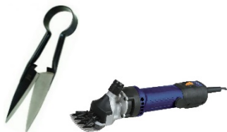
Рис. 4.13. Ножницы и стригальный аппарат для стрижки
