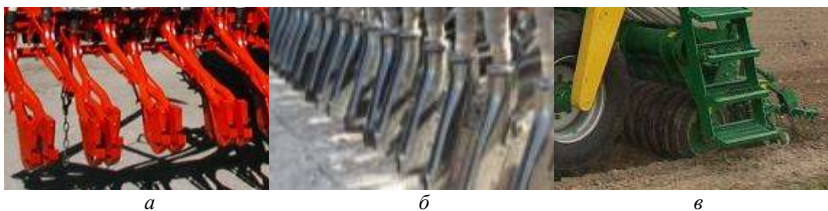
Рис. 1. Сошники, применяемые в посевных льяных машинах: а – анкерные; б – килевидные; в – дисковые
