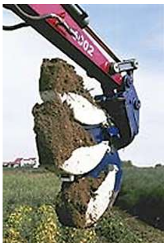
Рис. 1. Конструкция ковша для рытья узких траншей
