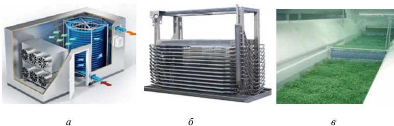
Рис. 23. Морозильные аппараты: а – конвейерный спиральный; б – многоплиточный; в – флюидизационный
