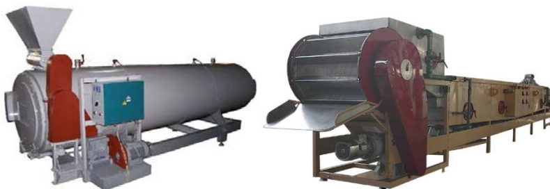
Рис. 21. Барабанный и ковшовый бланширователи
