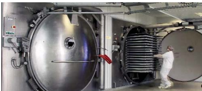
Рис. 24. Типы сушилок: a – шкафная; б – ленточная; в – вальцовая; г – сублимационная
