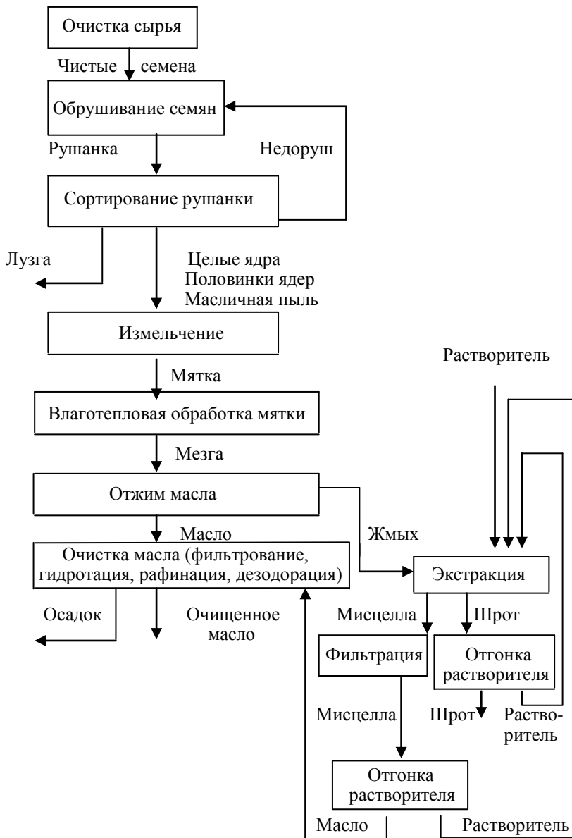
Рис. 26. Технологическая схема производства растительного масла
