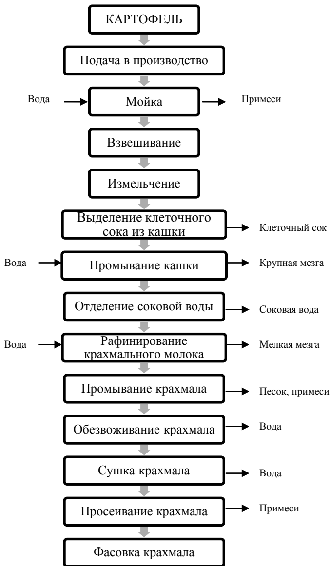
Рис. 32. Технологическая схема производства картофельного крахмала
