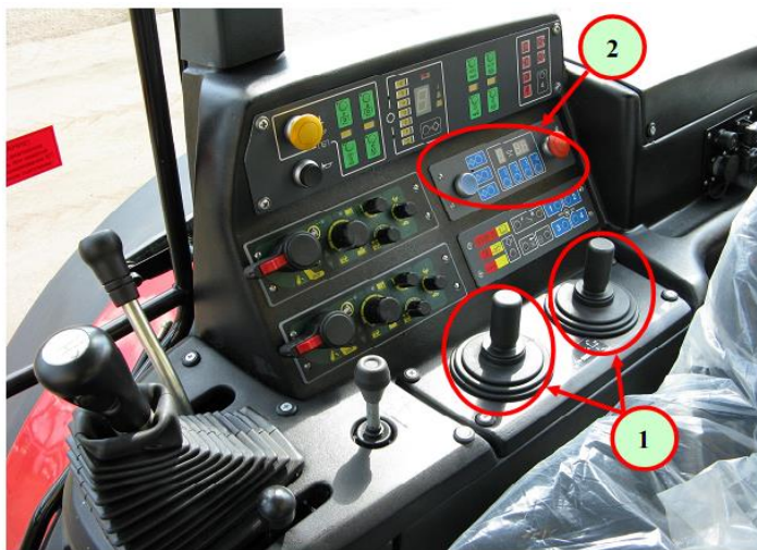
Рис. 3.51. Электронная система управления секциями ГНС: 1 – джойстики; 2 – электронный блок программирования последовательности операций (БПО) ГНС
