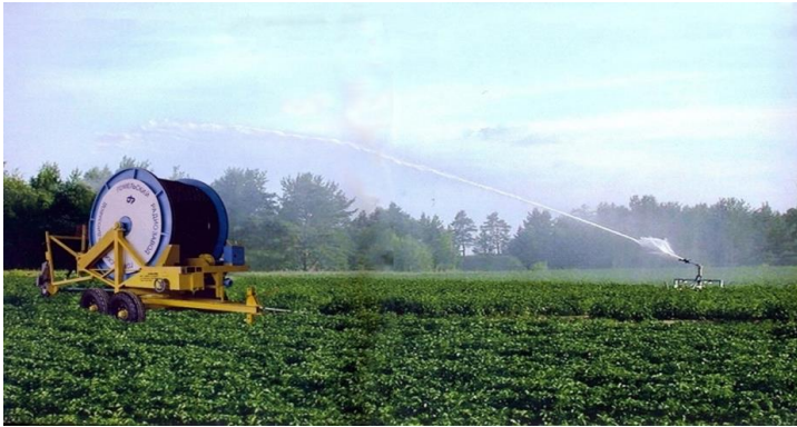
Рис. 5.16. Внешний вид шлангового дождевателя
