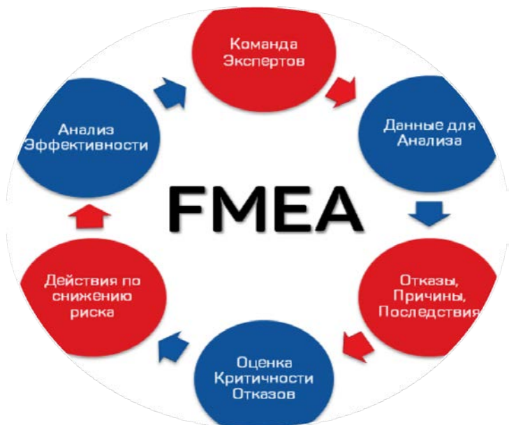
Рис. 1. Концептуальная классическая схема FMEA-анализа Источник: [13, 14]
