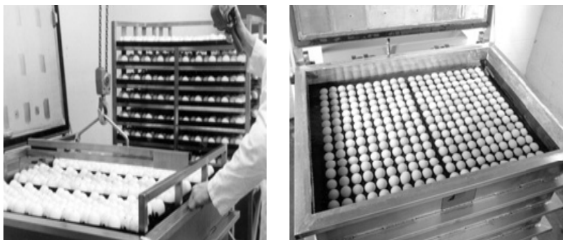
Рис. 4.1. Обработка инкубационных яиц методом прямого перепада давления
