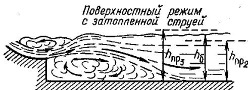
Рис. 4.7. Поверхностный режим сопряжения потоков в НБ сооружения
