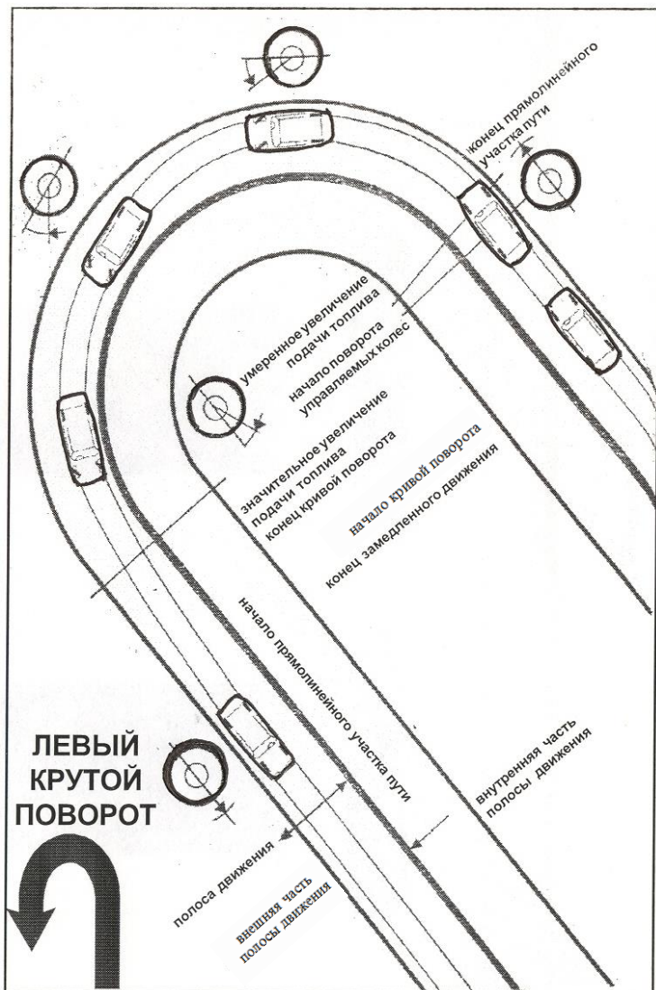
Рис. 6.20. Схема прохождения левого крутого поворота
