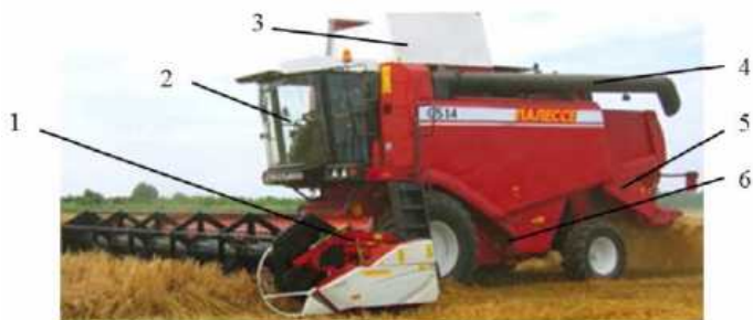
Рис. 8.10. Зерноуборочный комбайн «Палессе GS14»: 1 – жатка; 2 – площадка с кабиной управления; 3 – бункер; 4 – шнек выгрузной; 5 – соломоизмельчитель; 6 – система обмолота и очистки
