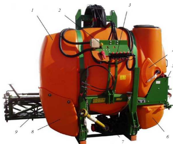
Рис. 7.3. Опрыскиватель навесной UF 1501: 1 – бак для раствора; 2 – регулирующий клапан; 3 – блок ручного управления; 4 – индикатор уровня наполнения; 5 – бак для пресной воды; 6 – бак-смеситель; 7 – насос; 8 – бак для промывочной воды; 9 – штанга
