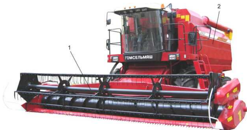
Рис. 8.2. Зерноуборочный комбайн «Палессе GS12»: 1 – жатка для зерновых культур; 2 – молотилка самоходная
