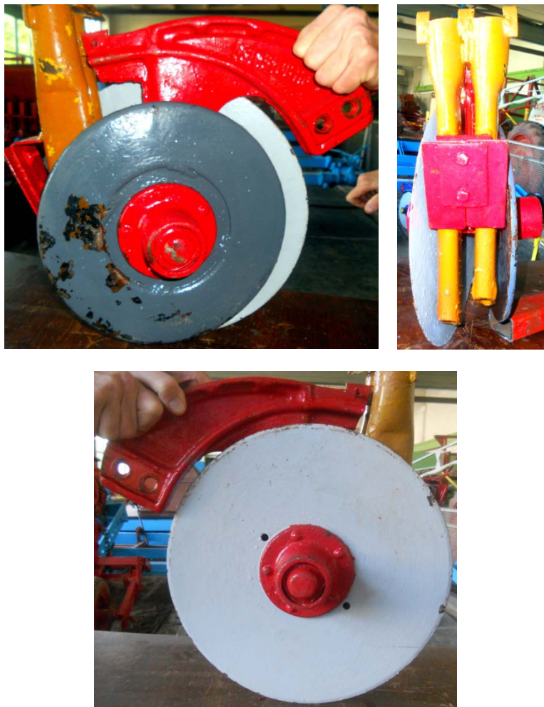
Рис. 4.75. Комбинированный двухдисковый сошник с разновеликими дисками для одновременного высева двух различных культур 8.8.3.(5.3).(7.5).3.1.3.1.8.8.3.1.4.8.6.3.(5.4).2.4.9.2
