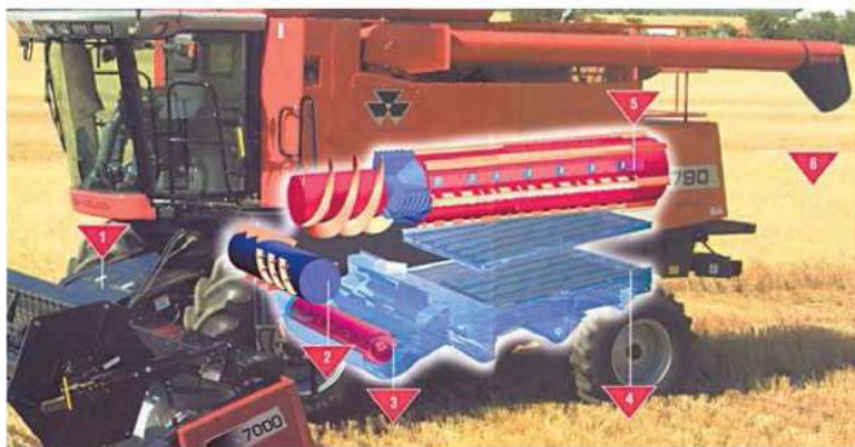
Рис. 8.18. Молотильно-сепарирующее устройство и система очистки зерна комбайнов «Massey Ferguson» серии 9000:
