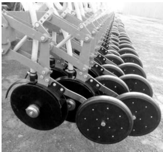
Рис. 4.71. Двухдисковые сошники с минимальным углом атаки дисков, с прикатывающим катком (производство ЕС) 3.1.1.2.1.2.3.7.4.2.3.3.3.2.1.4.2.2.2.3
