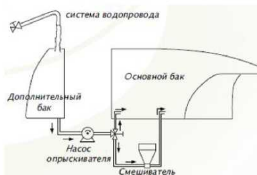
Рис. 7.6. Технологическая схема работы опрыскивателя «Теснома Laser 2540» по принципу «чистой воды»
