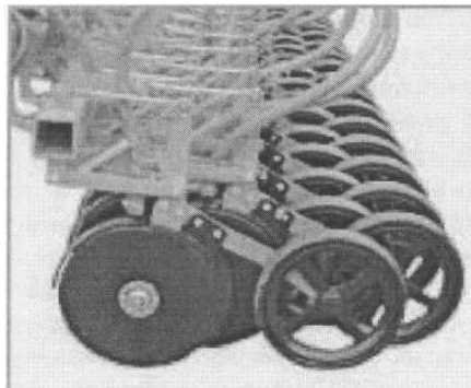
Рис. 4.25. Двухстрочный двухдискóвый сошник фирмы «Lemken» с ограничивающим глубину каточком
