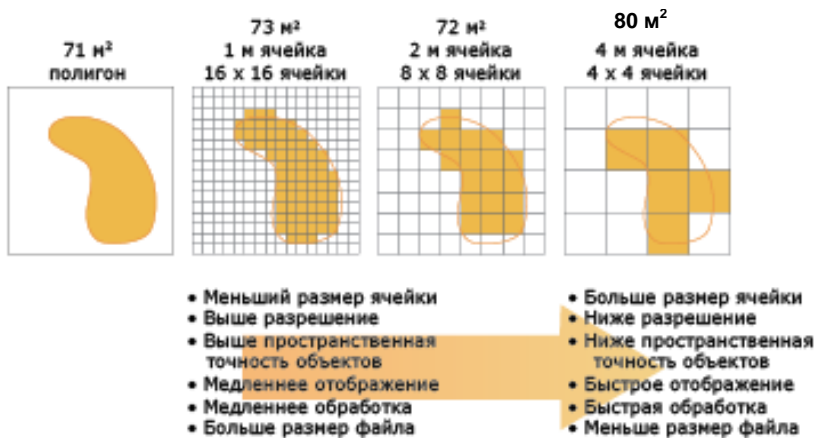
Рис. 2.3. Изображение с высоким (слева) и низким (справа) пространственным разрешением
