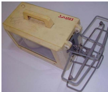
Рис. 13. Гигрограф суточный М-21С
