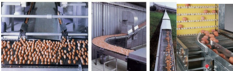
Рис. 47. Система сбора яиц
