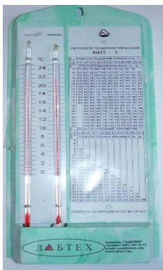
Рис. 10. Статический психрометр Августа
