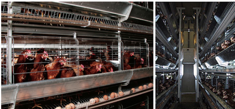
Рис. 48. Клеточная батарея для кур-несушек
