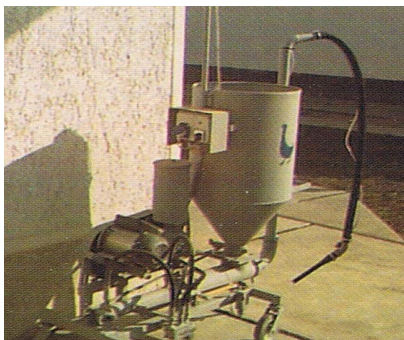
Рис. 41. Машина для принудительного откорма птицы
