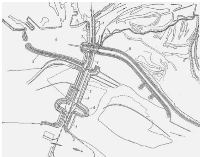
Рис. 1.38. Пример пойменной компоновки ГЭС: 1 – земляная плотина; 2 – водосливная плотина; 3 – здание ГЭС; 4 – повышающая подстанция; 5 – ограждающая дамба; 6 – аванпорт; 7 – судоходный шлюз; 8 – судоходный канал
