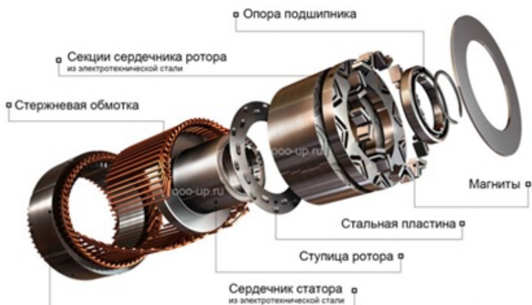
Рис. 3.7. Синхронный электродвигатель со встроенными постоянными магнитами
