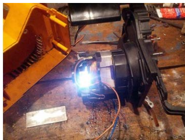
Рис. 4.20. Круговой огонь на коллекторе
