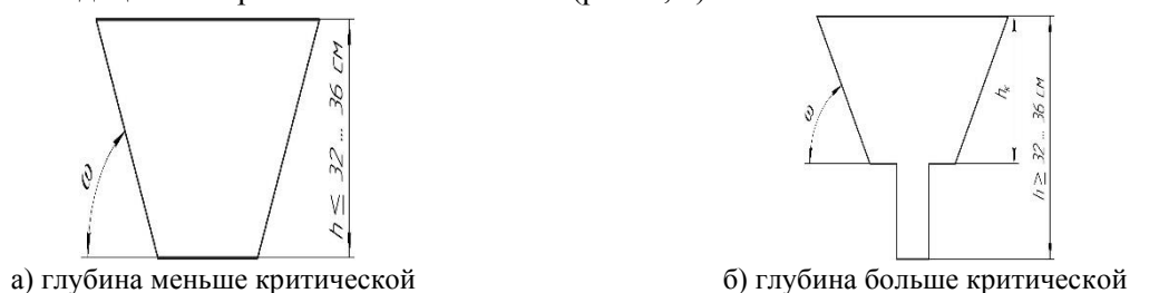
Рис. 1. Сечение полос почвы, разрыхленных на глубину меньшую и превышающую критическую
