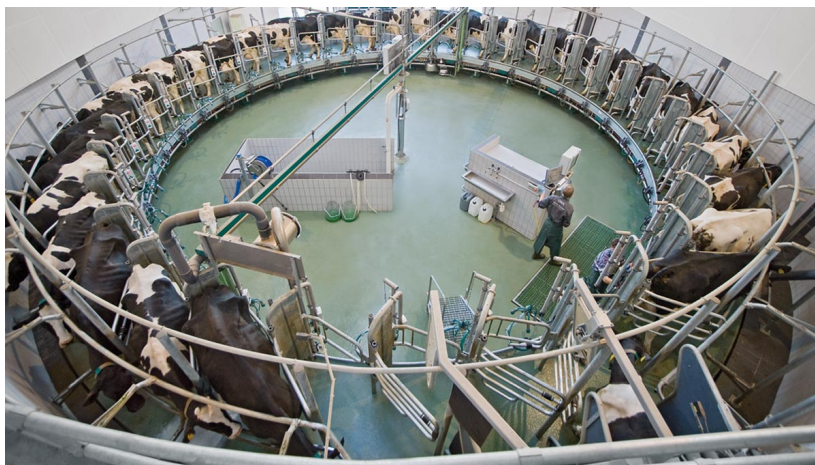
Рис. 6.4. Доильная установка типа «Карусель»
