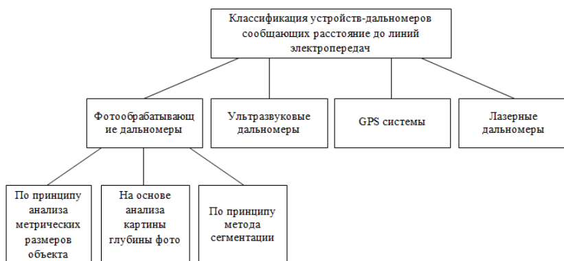
Рис. 1. Классификация устройств-дальномеров, сообщаящих расстояние до ЛЭП
