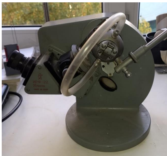
Рис. 1. Используемое оборудование – рефрактометр ИРФ-22
