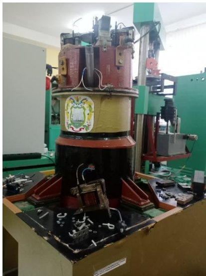
Рис. 1. Лабораторная установка с электромагнитным виброприводом
