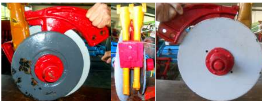
Рис. 2. Комбинированный двухдисковый сошник с разновеликими дисками для одновременного высева двух различных культур 8.8.3.(5,3).(7,5).3.1.3.1.8.8.3.1.4.8.6.3.(5,4).2.4.9.2
