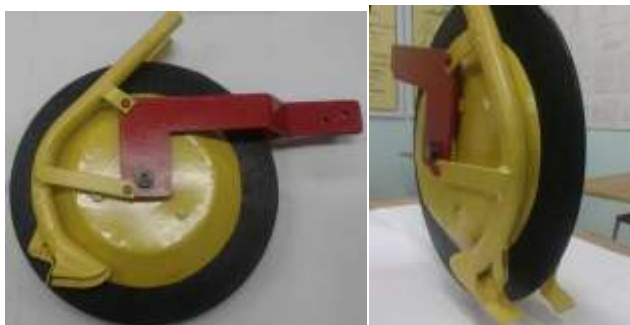
Рис. 1а. Однодисковый сошник с нулевым углом атаки
