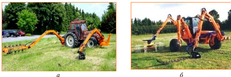
Рис. 4.78. Косилочные агрегаты: а – с сегментным косилочным с изогнутым брусом и грабельным цепным рабочим органом; б – с сегментным косилочным с изогнутым брусом и роторным грабельным рабочим органом
