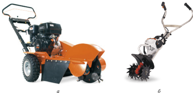
Рис. 4.107. Мотокультиваторы для угнетения растительности: a – с колесной опорой; б – без колесной опоры
