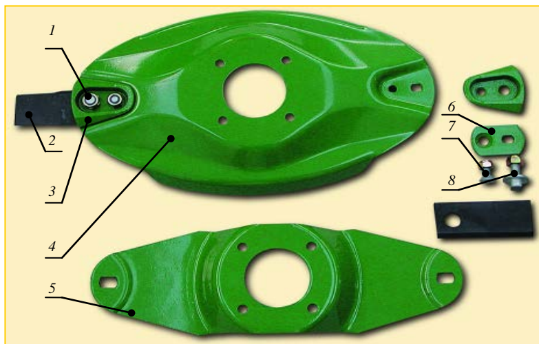
Рис. 4.42. Детали ротора косилок фирм Claas и Krone: 1 – гайки; 2 – ножи; 3 – прижим; 4 – диски; 5 – пружинное днище; 6 – шайбы; 7 – болт; 8 – палец
