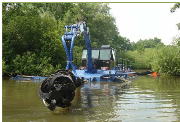
Рис. 8.7. Земснаряд с независимым поворотом грунтозаборного органа и выносными донными колесными опорами
