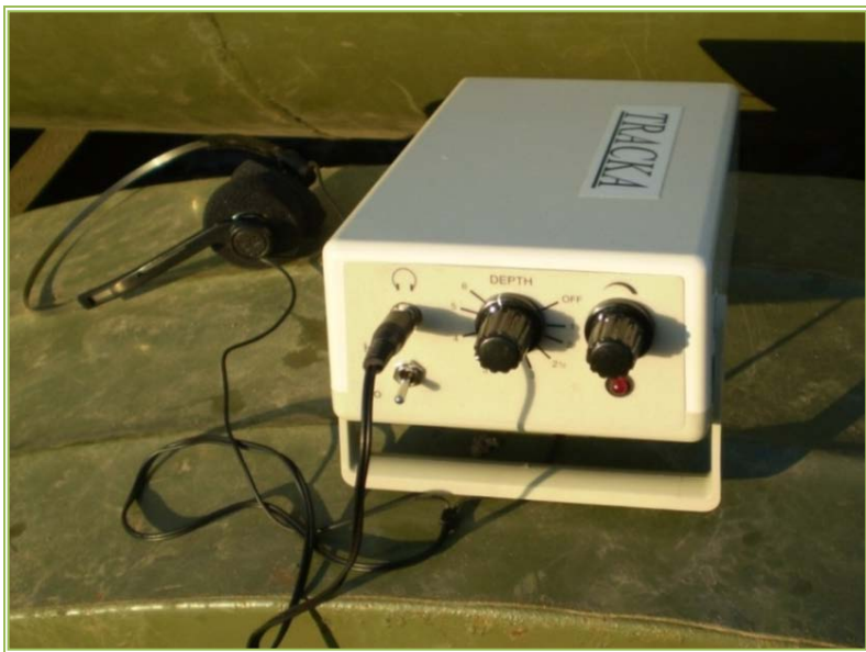
Рис. 6.36. Прибор для определения положения дренапромывочной головки
