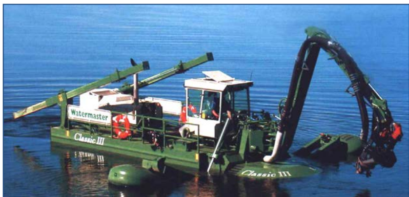
Рис. 2.69. Плавающая машина Watermaster: a – в работе; б – при перемещении вплавь; 1 – съемные передние стабилизаторы; 2 – понтон; 3 – рабочее оборудование; 4 – кабина; 5 – сваи; б – сервисный кран; 5 – съемные боковые понтоны
