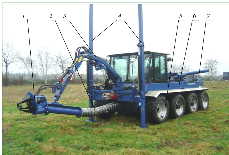
Рис. 8.5. Земснаряд-амфибия на многоопорном шасси с независимым поворотом грунтаборного органа и свайными опорами: 1 – грунтаборный орган; 2 – гибкая вставка; 3 – поворотная стрела; 4 – вертикальные опоры; 5 – пневматическое шасси; 6 – корпус; 7 – выбросная труба
