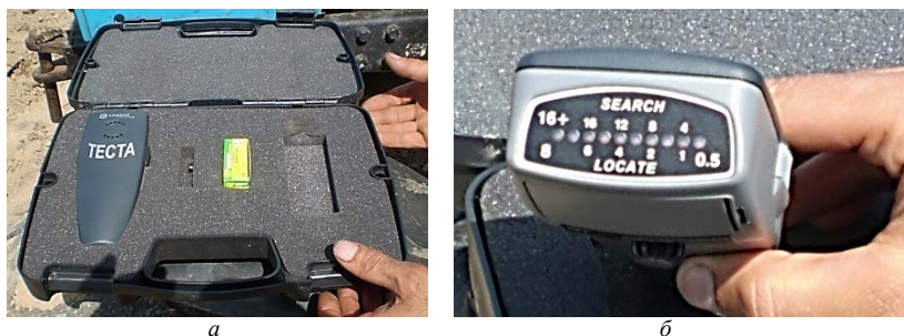
Рис. 6.44. Поисковое устройство ТЕСТА: а – вид в футляре; б – цифровая панель
