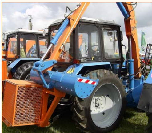
Рис. 3.2. Каналоочиститель многоцелевой ОКН с рабочим органом в транспортном положении
