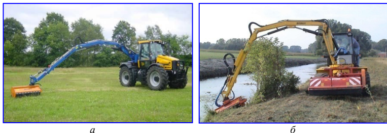
Рис. 4.67. Косилки-измельчители с рабочими органами: а – на поворотной платформе; б – навешенными фронтально и на поворотной колонке
