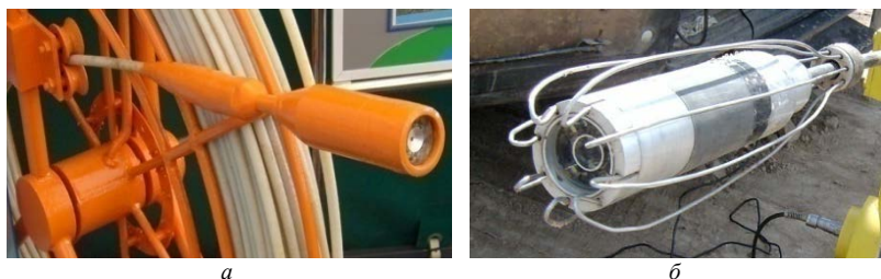
Рис. 6.41. Видеокамера с генератором сигнала комплекса КСД-160 в разных исполнениях
