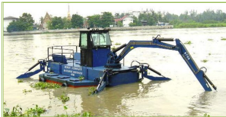
Рис. 2.66. Плавучая машина с аутригерами
