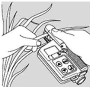
Рис. 3.13. Определение азота в листьях растений на приборе «N-Тестер»
