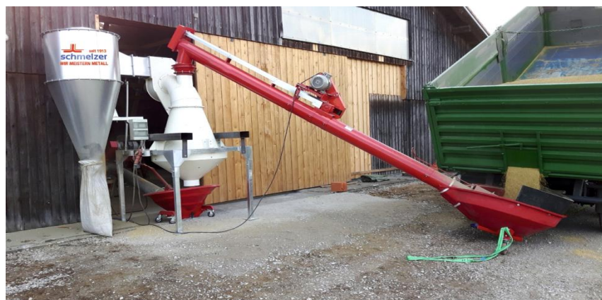
Рис. 3. Z-сепаратор в работе со шнеком и циклоном
