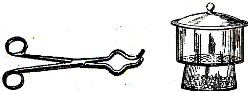
Рис. 2.3. Тигельные ножницы и эксикатор.
