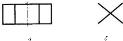
Рис. 128. Изображение гайки: a – упрощенное; б – условное
