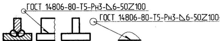
Рис. 159. Сварное соединение тавровое
