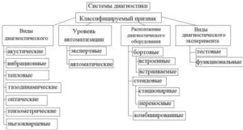
Рис. 1. Классификация диагностических систем
