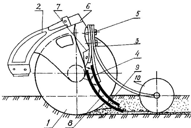
Рис. 1. Схема сошника для распределения и прикатывания семян по ленте: *1* – диски рабочие; *2* – корпус; *3* – поводок; *4* – распределитель; *5* – болт крепления; *6* – горловина; *7* – отражатель; *8* – пластина распределительная; *9* – пластина отражательная; *10* – каток прикатывающий
