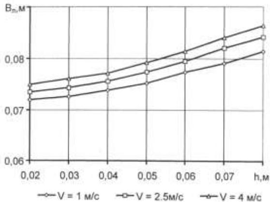
Рис. 4. Зависимость ширины высеваемой ленты  $B_{л}$  от глубины хода сошников  $h$  ( $D=0,35 \text{ м}$ )
