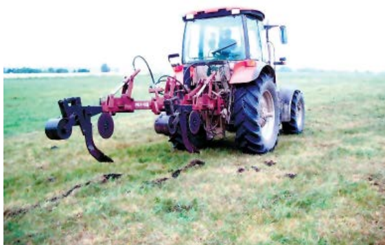
Рис. 10.5. Рыхлительное оборудование РКЛ-50 на базе рамы плуга ППП-3-40Б в агрегате с трактором МТЗ-1221
