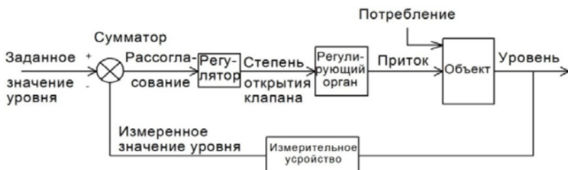
Рис. 4.3. Структурная схема АСР уровня в емкости
