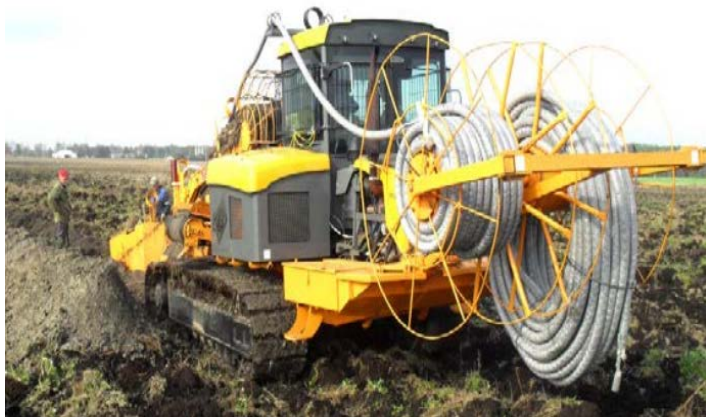
Рис. 11.2. Экскаватор-дреноукладчик с лазерным уклономером ЭТЦ-203
