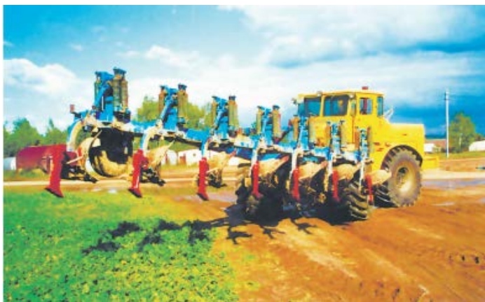
Рис. 10.4. Рыхлители плужной подошвы РПП-20 на плуге ППП-7-40 в агрегате с трактором К-701
