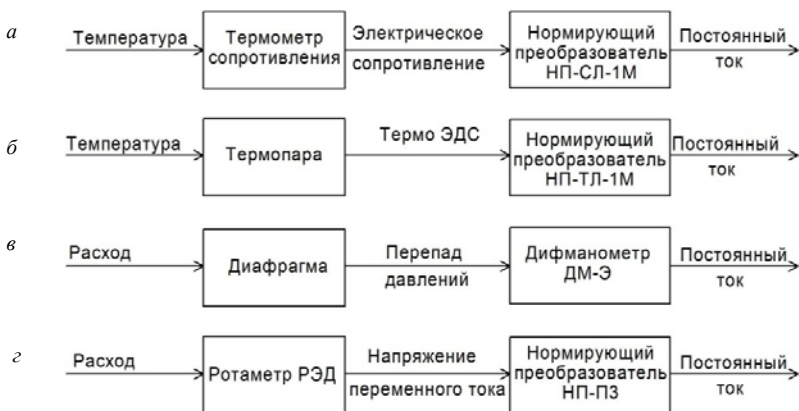
Рис. 4.19. Примеры измерительных цепей микропроцессорного регулятора: a – с термометром сопротивления; б – с термопарой; в – с диафрагмой; з – с ротаметром
