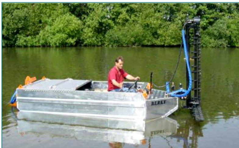
Рис. 3.92. Лодка-косилка с Т-образным рабочим органом.
