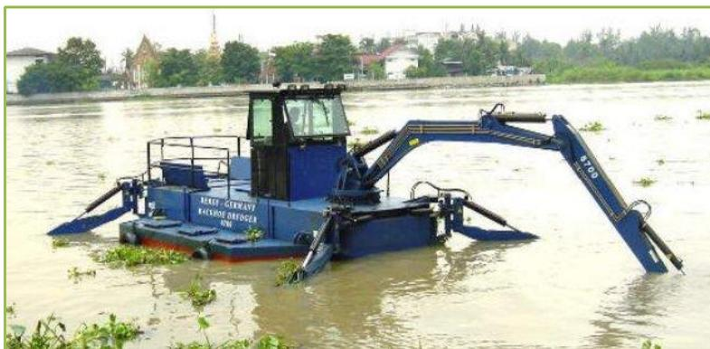
Рис. 2.57. Плавучая машина с аутригерами.
