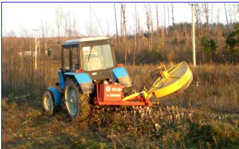
Рис. 3.22. Однороторная четырехножевая косилка КР-1,3.
