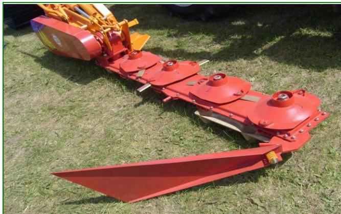
Рис. 3.40. Рабочий органа многороторной косилки АС-1.
