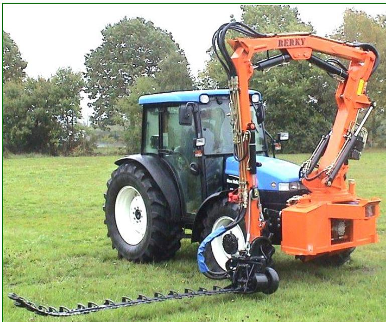
Рис. 3.11. Косилка с изогнутым двухножьевым режущим аппаратом.
