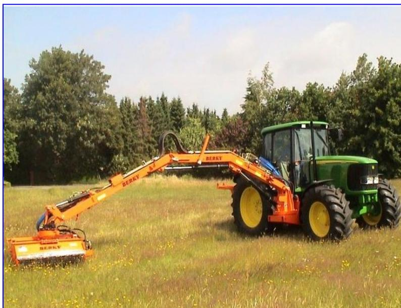
Рис. 3.61. Косилка-измельчитель с рабочим органом, навешенным сбоку.
