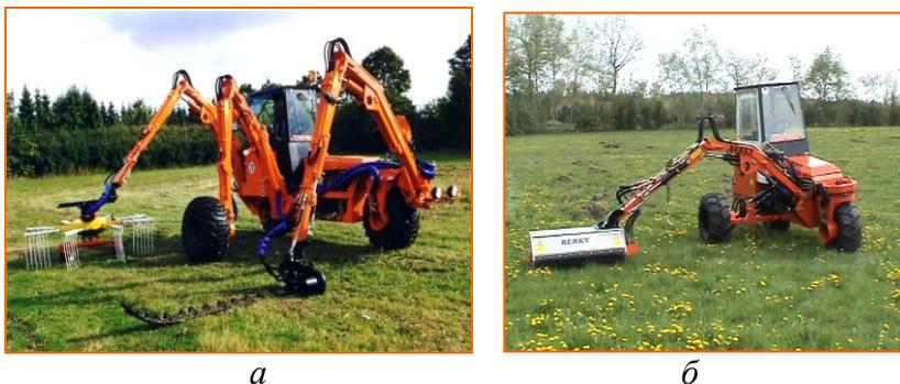
Рис. 2.48. Трехопорные каналоочистители фирмы Verku.
