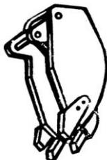
Рис. 4.2. Специальный ковш с удлиненными крайними зубьями.
