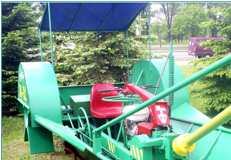
Рис. 3.90. Рабочий пост управления лодкой-косилкой ЛК-12.
