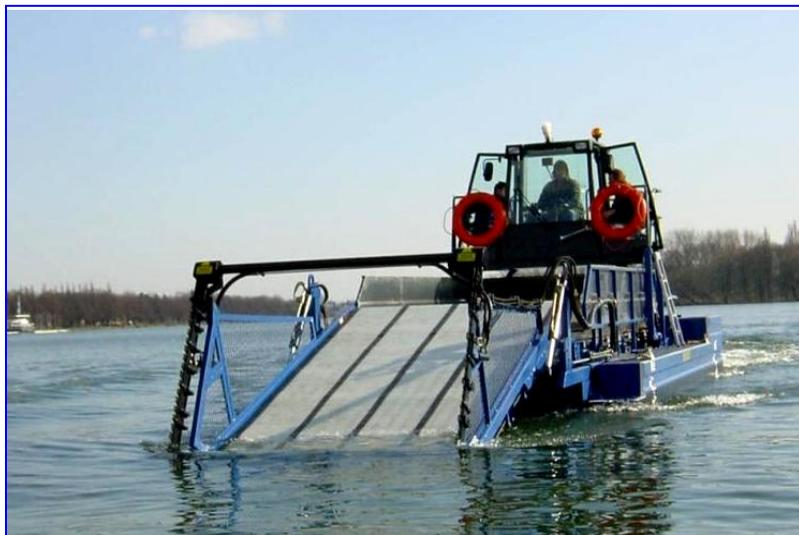
Рис. 3.106. Вид плавучего комбайна для удаления водной растительности.
