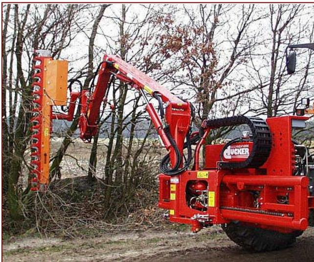
Рис. 3.19. Ножницы-кусторез на базе автомобиля.
