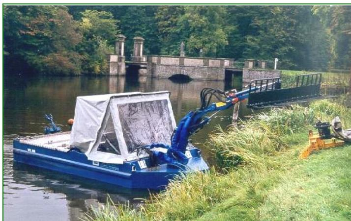
Рис. 3.101. Мотобот для сбора срезанной растительности.
