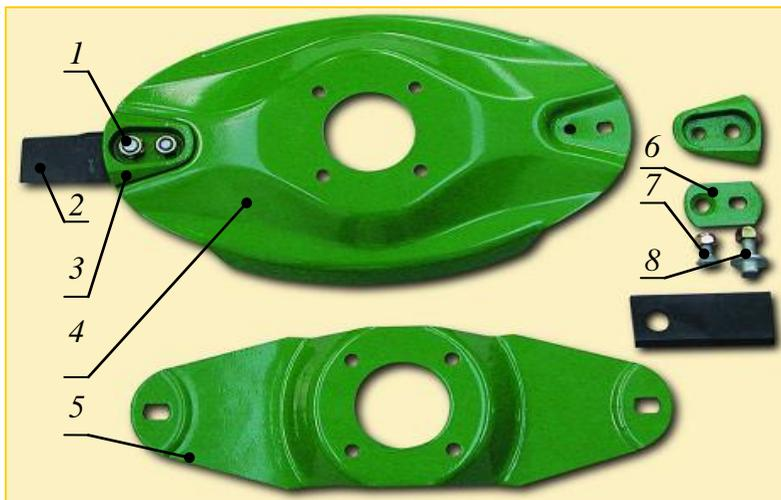
Рис. 3.50. Детали ротора косилок фирм Claas и Krone.
