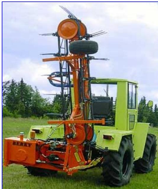
Рис. 3.74. Общий вид цепного подборщика в транспортном положении.
