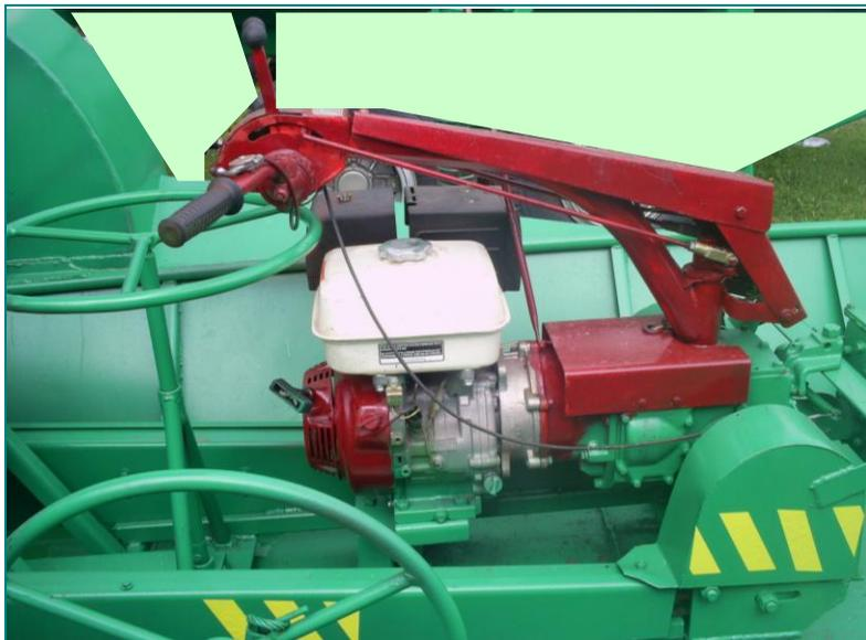
Рис. 3.91. Силовая установка лодки-косилки ЛК-12.
