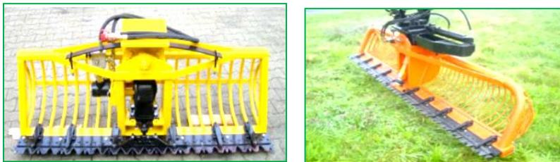
Рис. 3.67. Рабочие органы наклоняемых ковшей-косилок.
