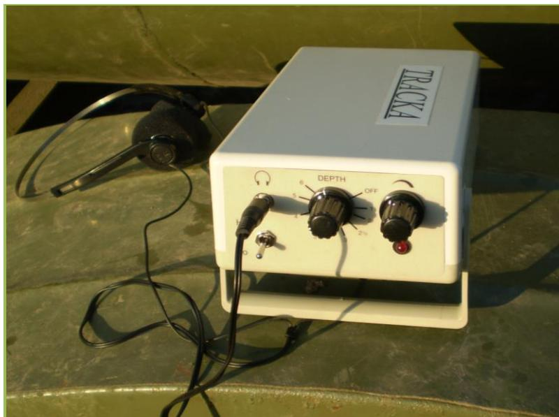
Рис. 4.39. Прибор для определения положения дренапромывочной головки.
