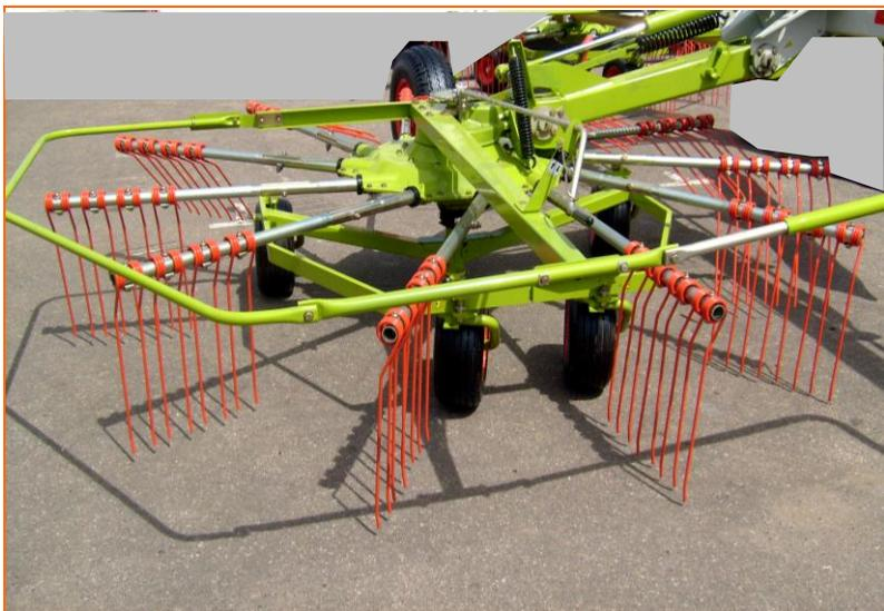
Рис. 3.77. Ротационный грабельный рабочий орган с механическим приводом.
