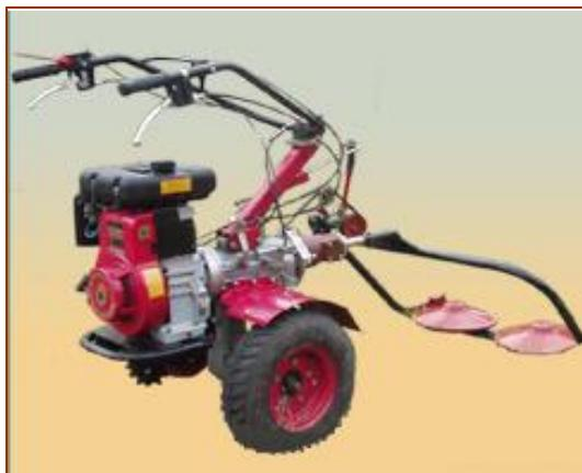
Рис. 2.53. Двухроторная косилка на мотоблоке.
