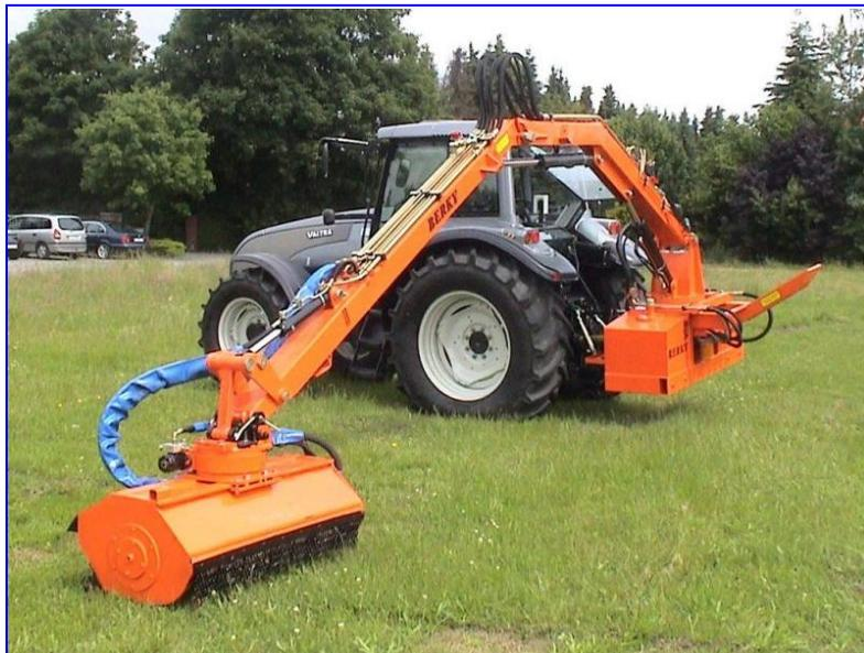
Рис. 3.62. Косилка-измельчитель с рабочим органом, навешенным сзади.
