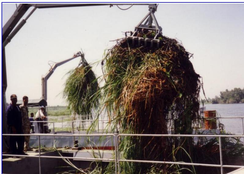
Рис. 3.107. Процесс выгрузки из бункера срезанной водной растительности.
