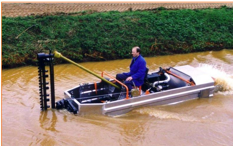
Рис. 3.87. Косилка с Т-образным рабочим органом.
