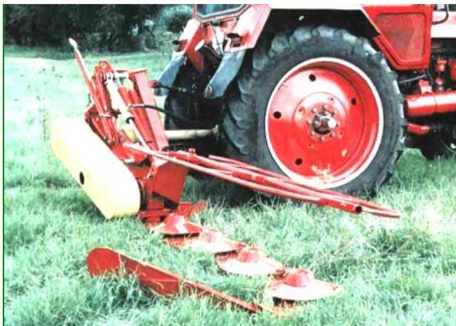
Рис. 3.38. Четырехроторная косилка КДН-210.
