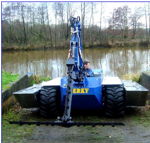
Рис. 3.100. Косилка-амфибия на колесном ходу.
