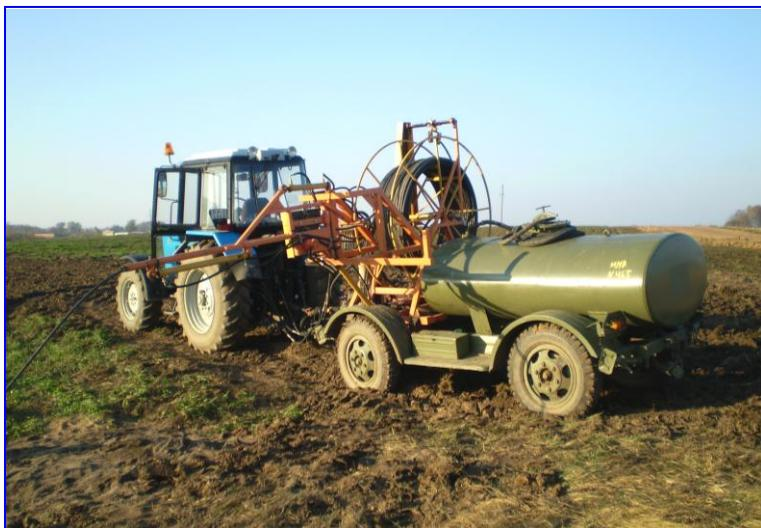
Рис. 4.29. Общий вид установки для промывки дренажа ДП-10А.
