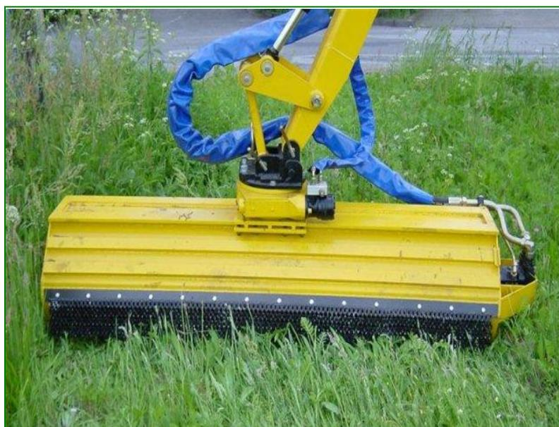
Рис. 3.59. Рабочий орган косилки-измельчителя.
