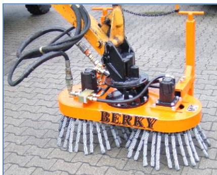
Рис. 2.28. Общий вид щеточного оборудования.
