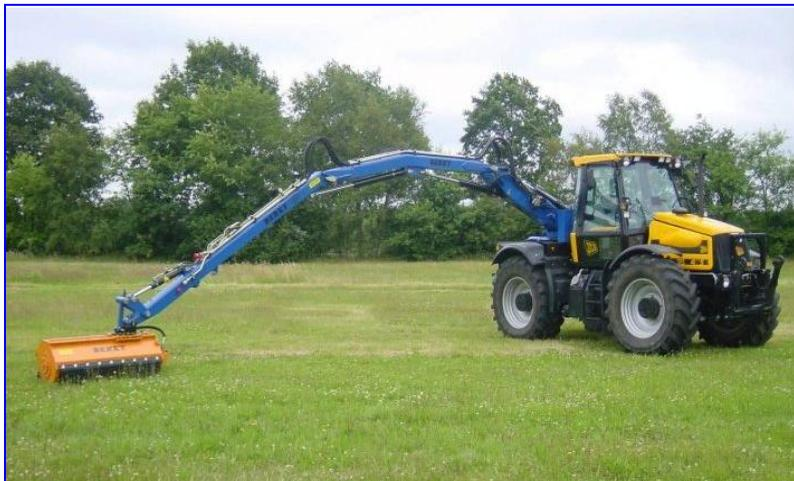
Рис. 3.60. Косилка-измельчитель на поворотной платформе.
