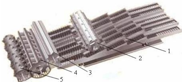
Рис. 12. Соломотряс зерноуборочного комбайна «ПАЛЕКСЕ GS14»: 1 – клавиши соломотряса; 2 – активатор; 3 – отбойный битер; 4 – молотильный барабан; 5 – барабан-ускоритель
