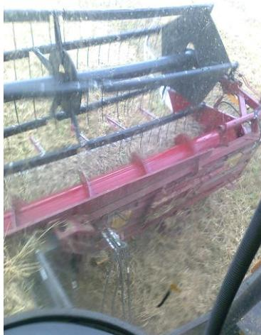
Рис. 4.8. Работа мотовила на коротком стеблестое
