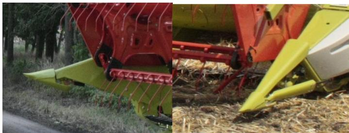
Рис. 4.6. Установка делителей торпедного типа
