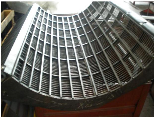
Рис. 5.4. Экспериментальное подбарабанье с дифференцированной рабочей поверхностью
