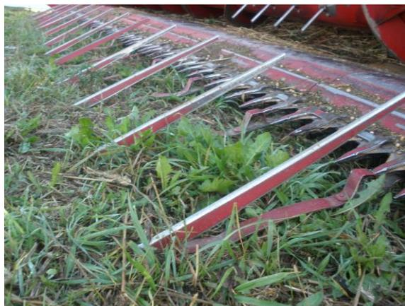
Рис. 4.11. Установка стеблеподъемников на комбайнах «ПАЛЕССЕ GS»
