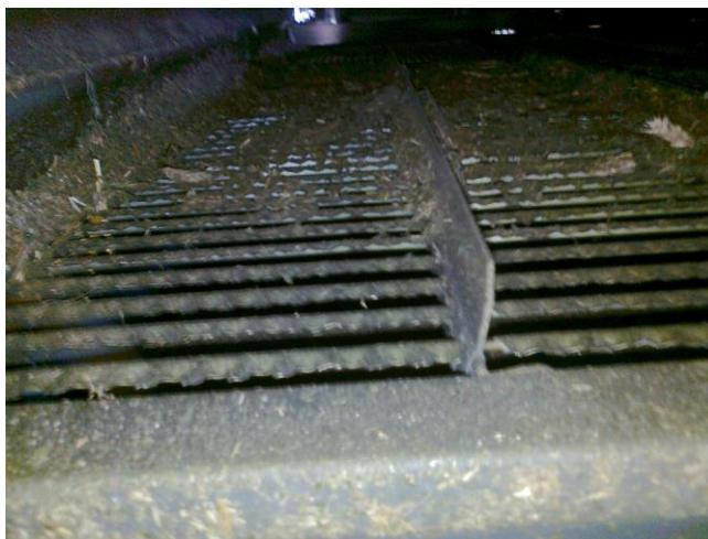
Рис. 6.7. Последствия неравномерного обдува решет очистки
