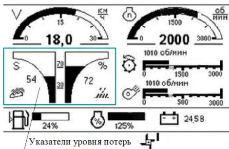
Рис. 7.6. Режим «комбайнирование» на мониторе «БКИ-03»
