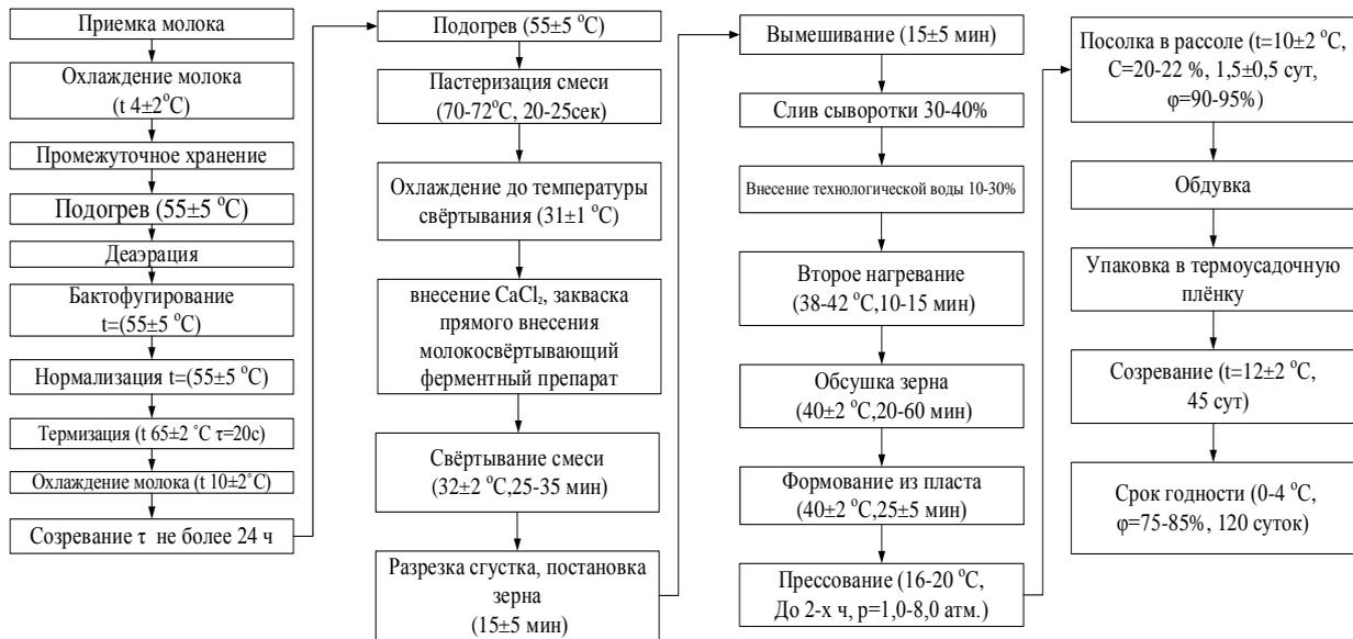
Рис. 1. Технологическая схема производства сыра
