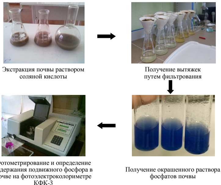
Рис. 1. Алгоритм испытаний почвенных образцов на содержание подвижных форм фосфора по методу Кирсанова
